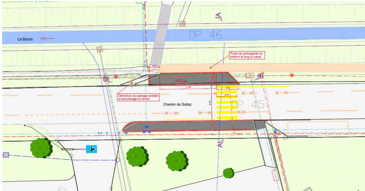
Figure 4 : Esquisse des aménagements proposés pour la traversée du chemin de la Sallaz
