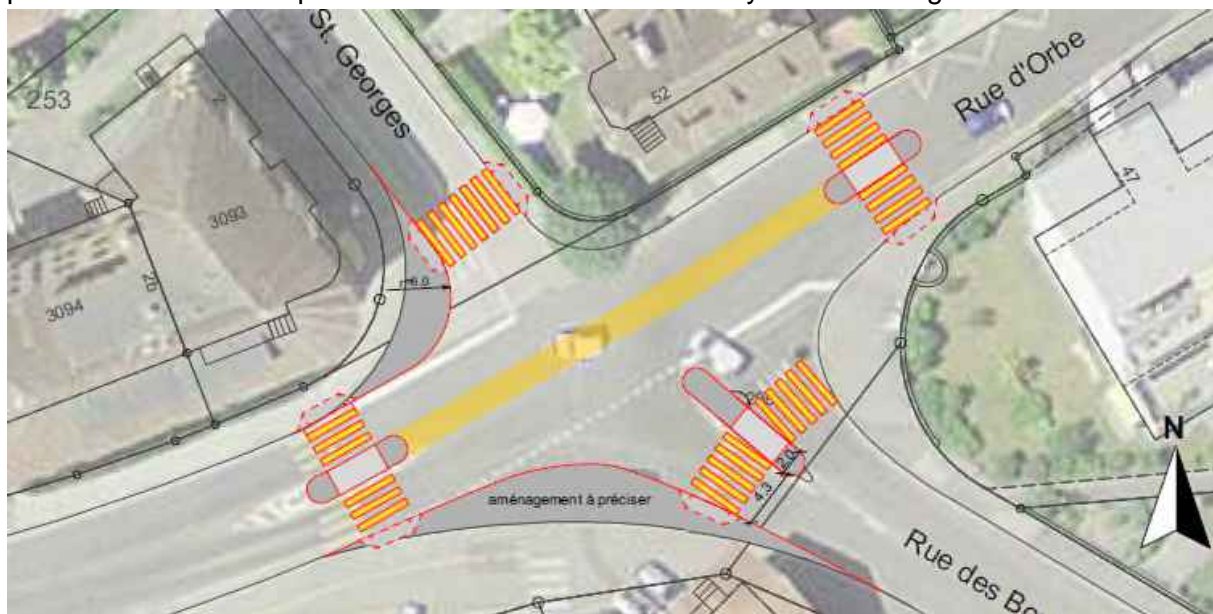
Figure 3 : Esquisse des aménagements proposés sur le carrefour Bouleaux/Orbe/St-Georges
